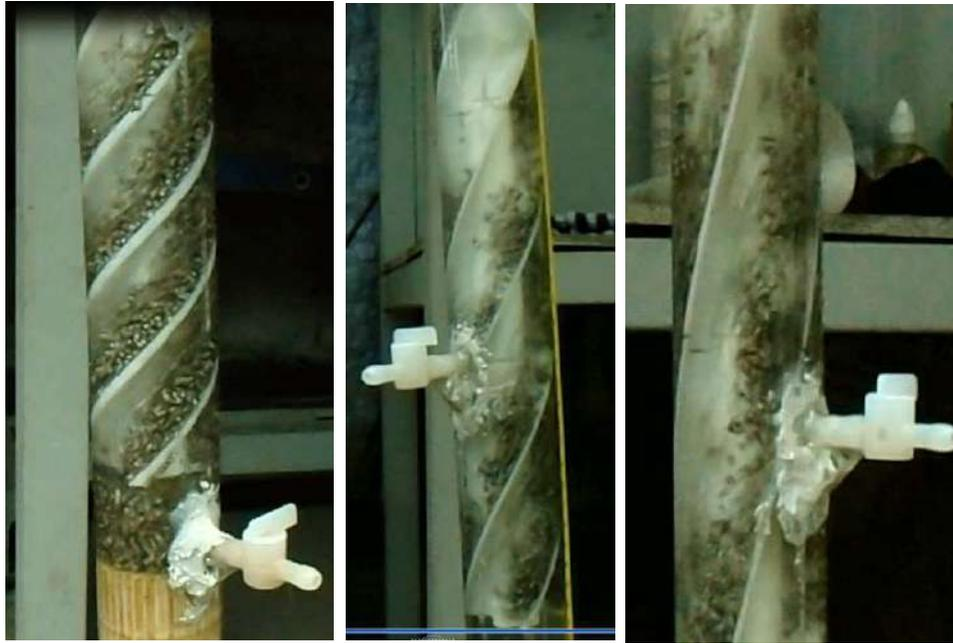
Figura 28 Baffle con 3 arranques (de izquierda a derecha) a 45°, 60° y 75°.
