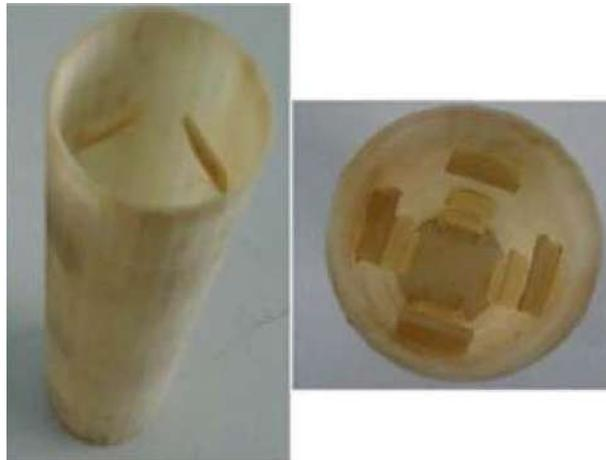
Figura 4 Estabilizador de flujo.
