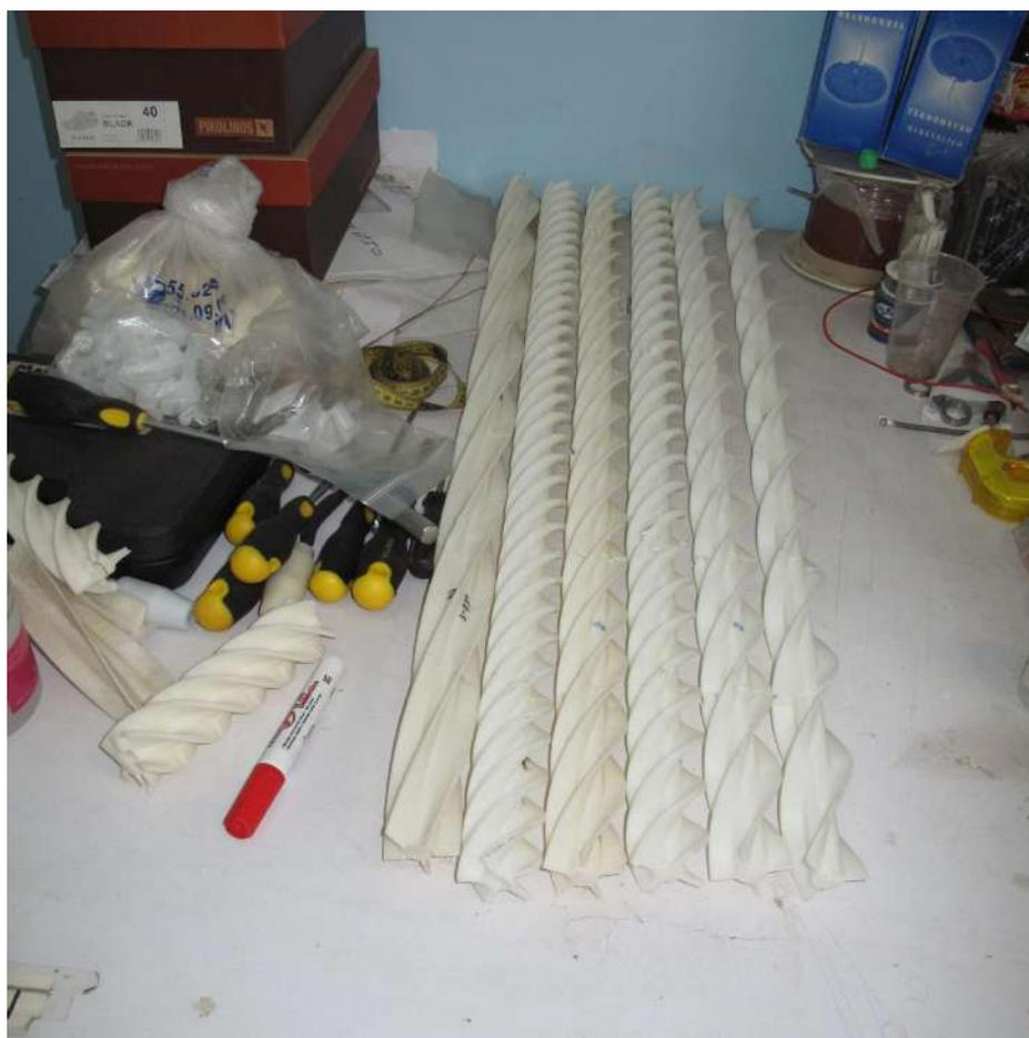
Figura 5 Baffles espirales con variaciones de inclinación y diámetro hidráulico de los canales de flujo.
