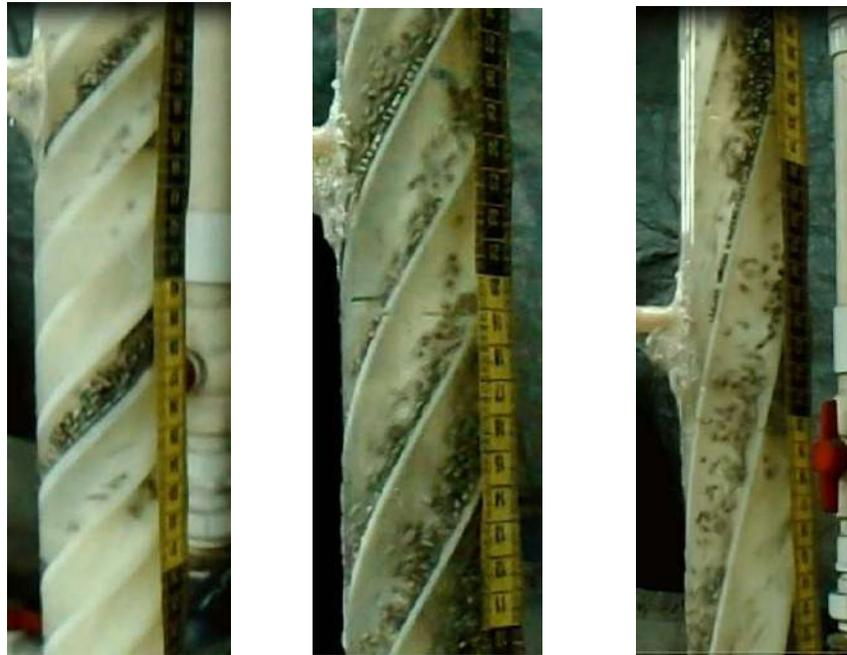
Figura 30 Baffle con 5 arranques (de izquierda a derecha) a 45°, 60° y 75°.
