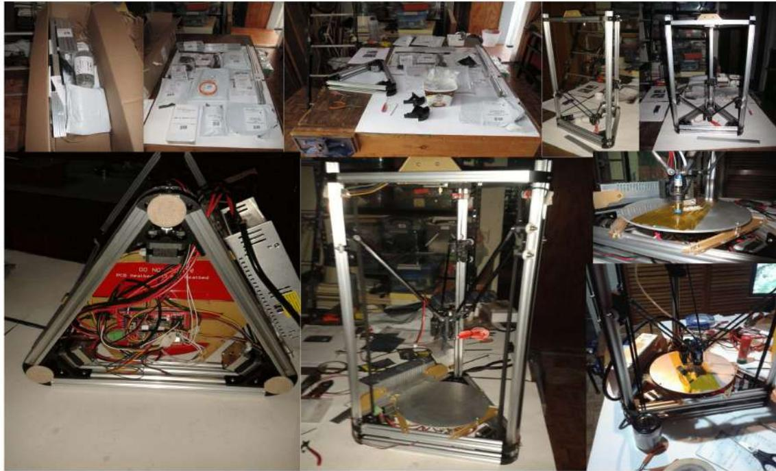
Figura 11 Ensamble de la impresora 3D tipo 'Delta'.
