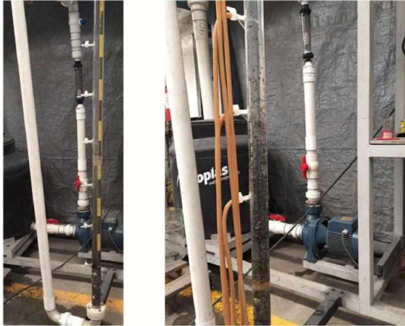
Figura 10 Equipo para fluidización de partículas.
