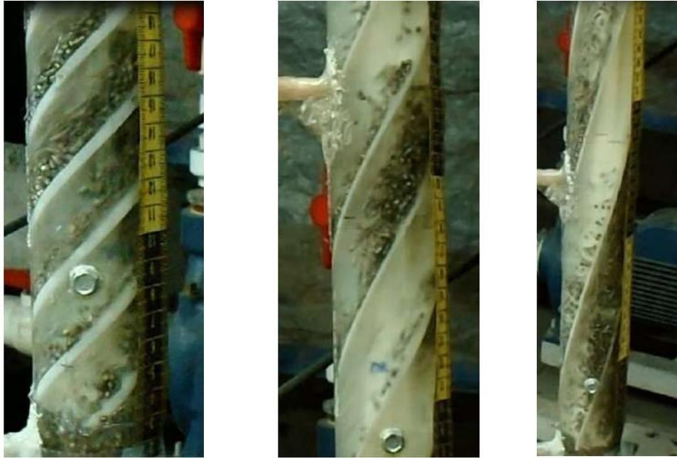
Figura 29 Baffle con 4 arranques (de izquierda a derecha) a  $45^\circ$ ,  $60^\circ$  y  $75^\circ$ .
