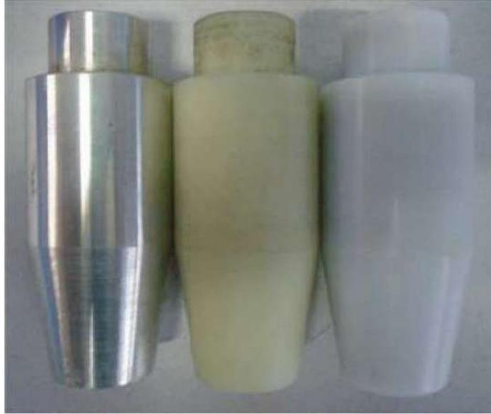
Figura 8 Flotadores para ampliar el rango de medición del rotámetro.
