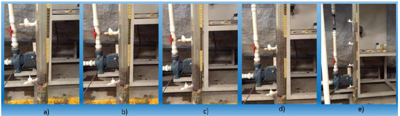
Fig. 4 Figura 1 Modelo experimental; partículas sólidas de material de Plomo con un d_p = 2.49 mm, ( \rho ) = 12370 Kg/m 3 . Este estudio describe el comportamiento de la fluidización a diferentes flujos de entrada al sistema: a) 4 gal/min, b) 7 gal/min, c) 10 gal/min, d) 15 gal/min y e) 18 gal/min.
