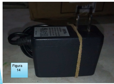
Figura 14. Las fuentes de alimentación permiten energizar primero a la tarjeta de control con un requerimiento de 5 volts de cc y 3 amper, mientras que la fuente para el accionamiento de los motores debe contar con una salida de 12 volts de cc y 5 amper.
