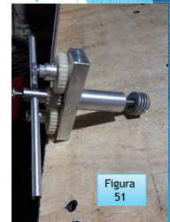
Figuras 49, 50 y 51. Primer modelo funcional de pruebas para perno de vigas hiperestáticas con Sistema de testigos de esfuerzos contrarios en nodo.
