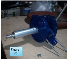
Figura 52. Segundo modelo de pruebas para perno de vigas hiperestáticas con engranaje centrado en forma colineal (vista posterior).
