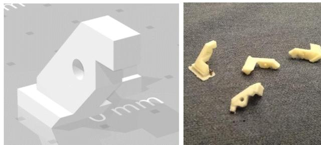
Botón para activación del indicador de carga de la fuente de poder (archivo digital e impresiones 3D)
