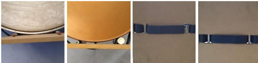
Detalles en vista superior y frontal de los elementos de ajuste para diferentes diámetros de columnas del soporte secundario.
