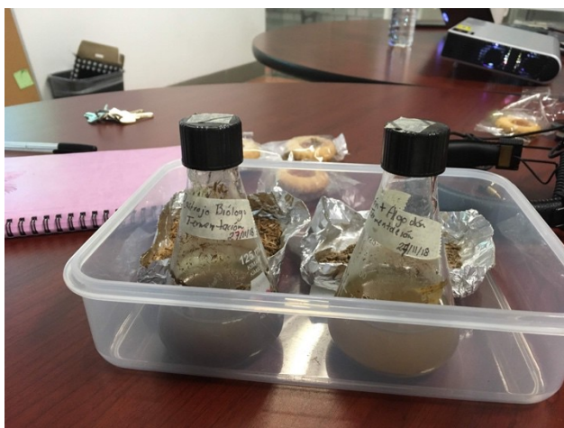
Fig. 2 Pruebas de laboratorio para la producción de bioetanol a partir de sustrato de cultivo de hongos
