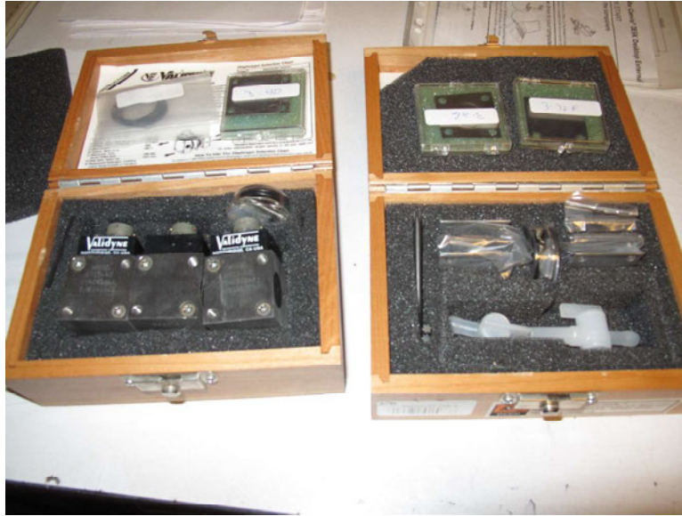
Figure 17 Kit de múltiples rangos de medición de presión diferencial y tres transductores con una selección de diafragmas adicionales.
