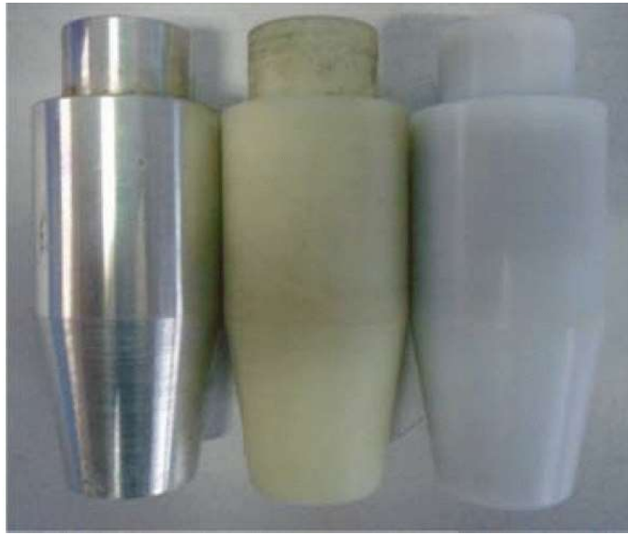
Figure 19 Flotadores para ampliar el rango de medición del rotámetro.
