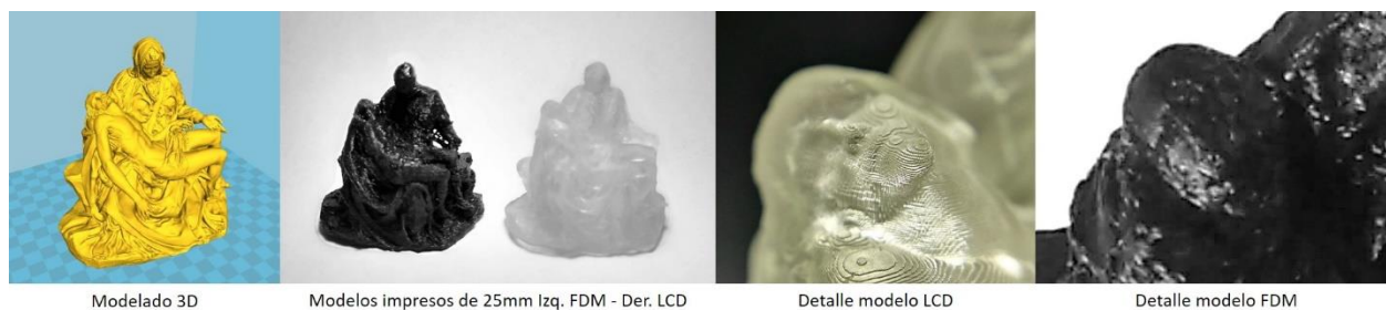
Figura 2. Muestra comparativa de nivel de fidelidad de modelo impreso en FDM y LCD
