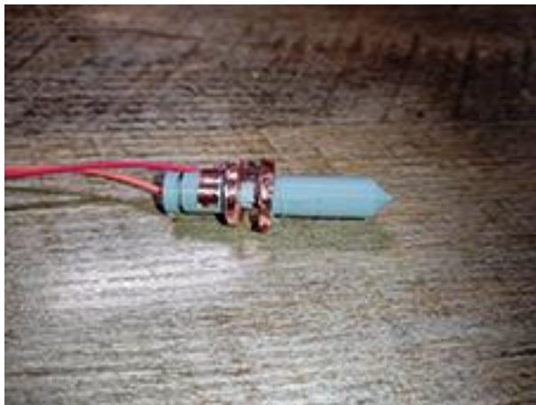
Fotografías sensor de contacto con lámina de cobre y cables (+ y -).
